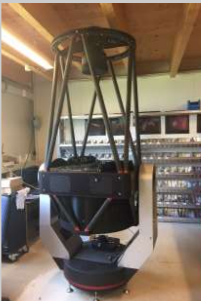
為紫金山天文台建造的 0.8 米口徑 f/10 RC 望遠鏡 設於雲南站。 0.8m f/10 RC telescope built for Yunnan station of Purple Mountain Observatory.
