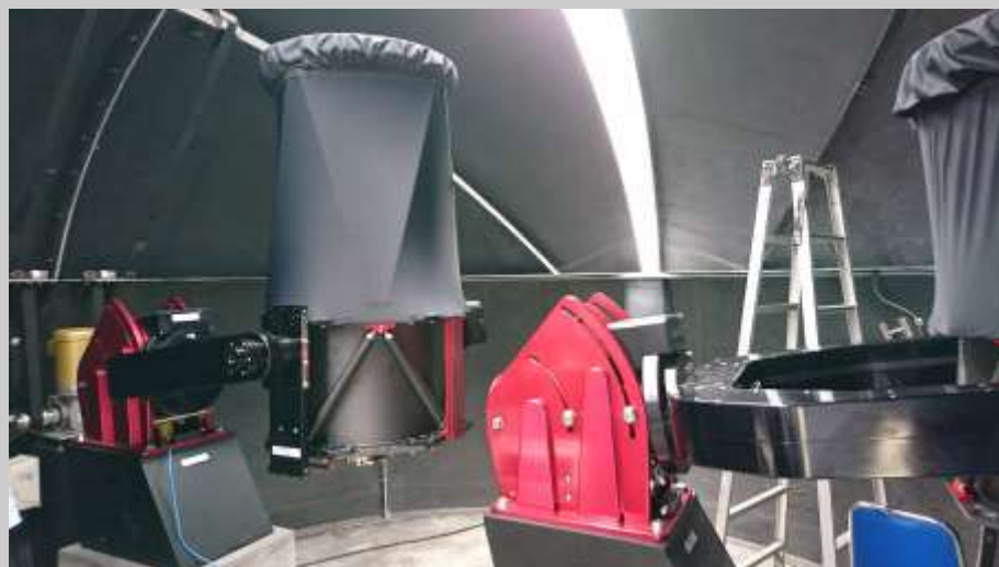
印尼國立航天研究所(LAPAN)項目所使用的天文台圓頂及兩台 0.5 米口徑望遠鏡 The observatory dome with two 0.5 meter telescopes for the Indonesia Space agency (LAPAN)
