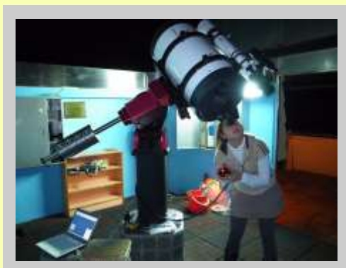
香港西貢白普里營天文台自動化赤道儀 Automated equatorial mount in Bradbury camp Sai Kung
