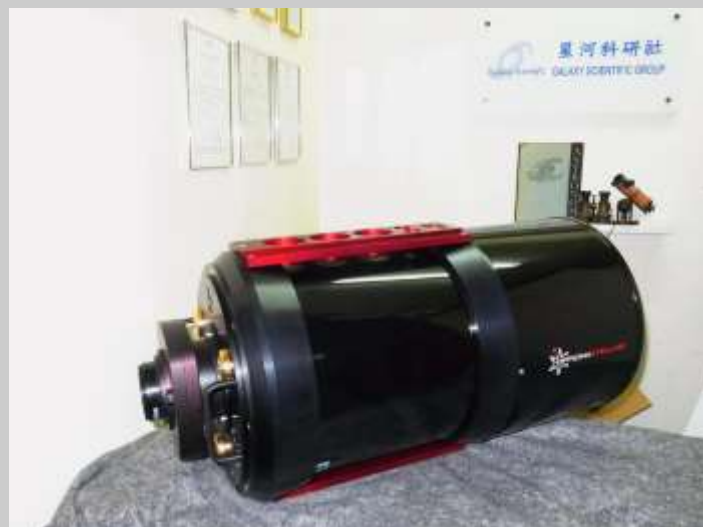
台灣大學墾丁天文台 0.3 米口徑 f/3 大像 場望遠鏡 0.3 meter aperture f/3 wide field telescope for KTO Taiwan University
