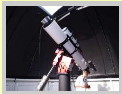
保良局顏寶鈴書院太陽觀測用全球最大 16 公分腔振濾鏡 (截至 2010 年) 16cm clear aperture, the world's largest etalon for solar observation, of PLK Ngan Po Ling College (as of 2010)
