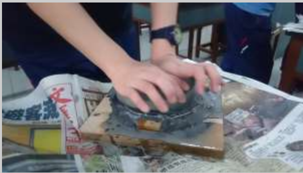
磨製 150 口徑反射鏡 Lapping of a 150mm aperture mirror
